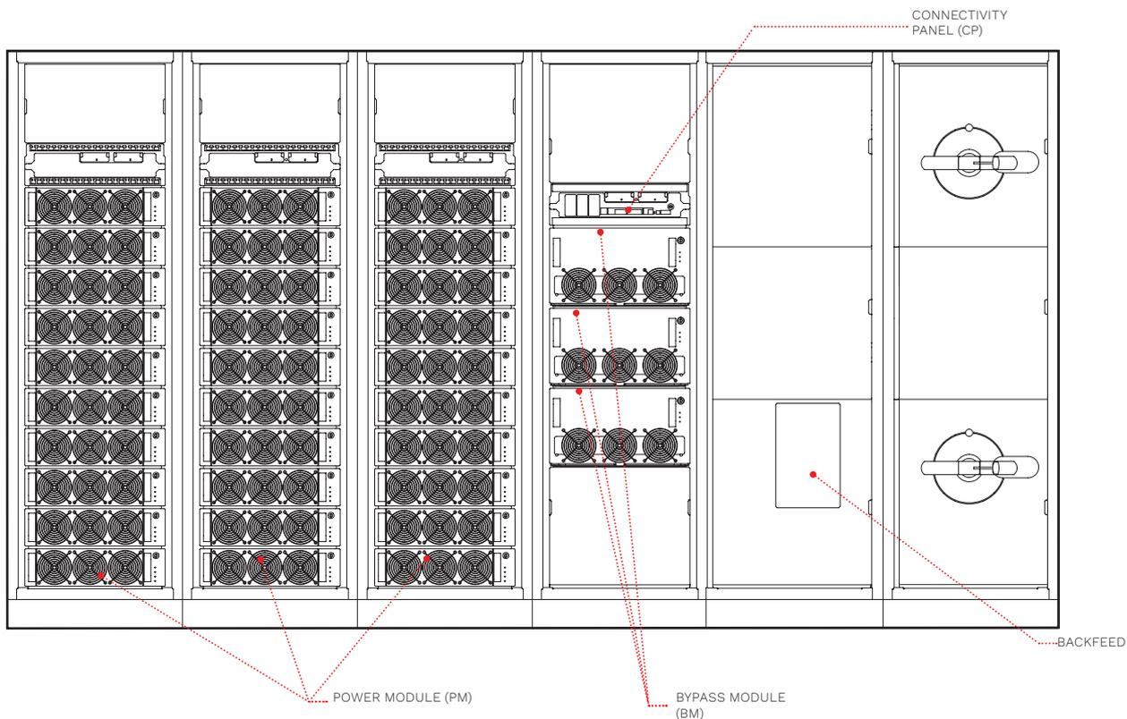
Note : Les images de présentation des systèmes sont uniquement à des fins d'illustration et représentent l'unité principale. Les dimensions, les configurations et le nombre de modules effectifs varient en fonction de la puissance et de la redondance requises.
