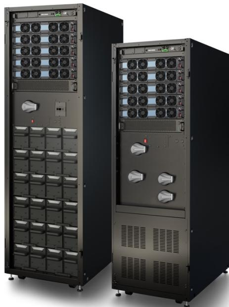
M2X 120 CBC 6 (Combo Cabinet con batterie integrate) combina fino a 5 Power Module, 6 stringhe di batterie, switch di batteria e di manual bypass all'interno di un unico armadio. L'ingresso cavi è sia dall'alto che dal basso.
