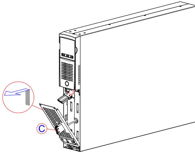
4. Sfilare il battery pack tirandolo verso l'esterno, come mostrato nella la figura sottostante. Prestare attenzione nell'estrazione e sollevamento del battery pack, poiché il suo peso è considerevole. **ATTENZIONE:** il nuovo battery pack dovrà contenere lo stesso numero e tipo di batterie (vedi etichetta posta sul battery pack vicino al connettore).
