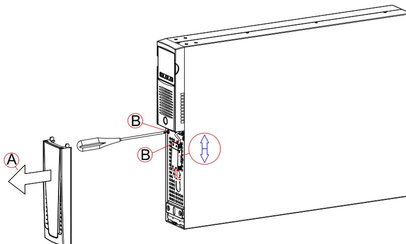
3. Togliere il pannello di ritenzione del battery pack eseguendo i movimenti esposti nella figura sottostante
