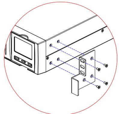
**NOTE:** Nell'installazione rack dato il peso elevato è obbligatorio l'utilizzo delle staffe di sostegno (guida con supporto a L). Sempre per lo stesso motivo, è consigliabile installare l'UPS e il Battery Box nella parte bassa dell'armadio rack.
