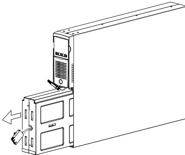
5. Inserire nel vano il nuovo battery pack facendolo scorrere all'interno dell'UPS. Rimettere in posizione il pannello di ritenzione del battery pack e fissarlo con le due viti tolte in precedenza. Collegare il cavo del battery pack all'UPS e richiudere il pannello frontale. Portare l'UPS nella modalità di funzionamento normale premendo i tasti ON+SEL per almeno 4 sec.
